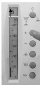
Al pulsar las teclas **+** o **-**, el cuadro que parpadea lentamente (el que indica el valor de la temperatura de funcionamiento programada) empieza a parpadear rápidamente. Posteriores pulsaciones sobre las teclas **+** o **-** desplazan el cuadro en cuestión hacia arriba o hacia abajo, respectivamente.
