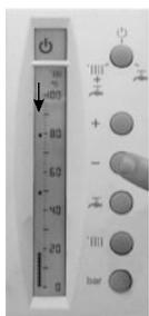
Dejar de pulsar cuando el cuadro haya adoptado en la escala el lugar que corresponde al nuevo valor deseado para la temperatura de funcionamiento de la caldera o del depósito. Al cesar el parpadeo rápido, o al pulsar las teclas **|||||**, **⏏** o **bar**, la nueva temperatura se habrá introducido en la memoria del cuadro.
